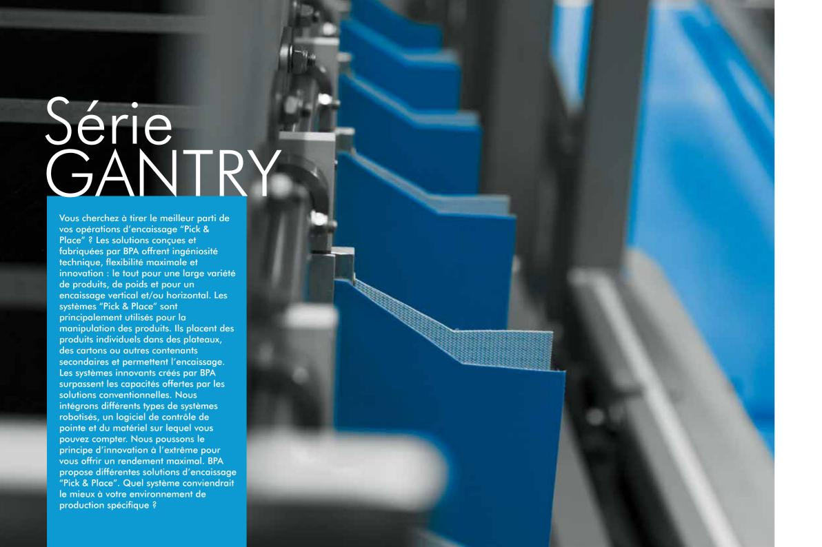
La GANTRY 100 est un système d'encaissage robotisé "Pick & Place" travaillant sur deux axes. Sa conception modulaire permet une configuration sur mesure de la gestion des emballages souples et autres conditionnements difficiles à manipuler, incluant les "sachets doypacks", les "sachets coussin" et les sachets Quatro Seal. Cette machine est spécialement conçue pour un travail à
