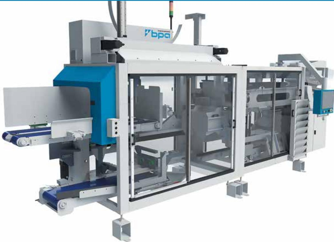
Nuestra serie Cubemaster ha sido diseñada, originalmente, para el encajado en vertical de patatas fritas congeladas. El encajado vertical reduce el índice de rotura de las patatas durante el transporte, y lo distribuye de manera uniforme entre todas las bolsas de la caja. De esta forma, se reduce considerablemente la merma de producto en el proceso global de la manufactura de patatas fritas.
