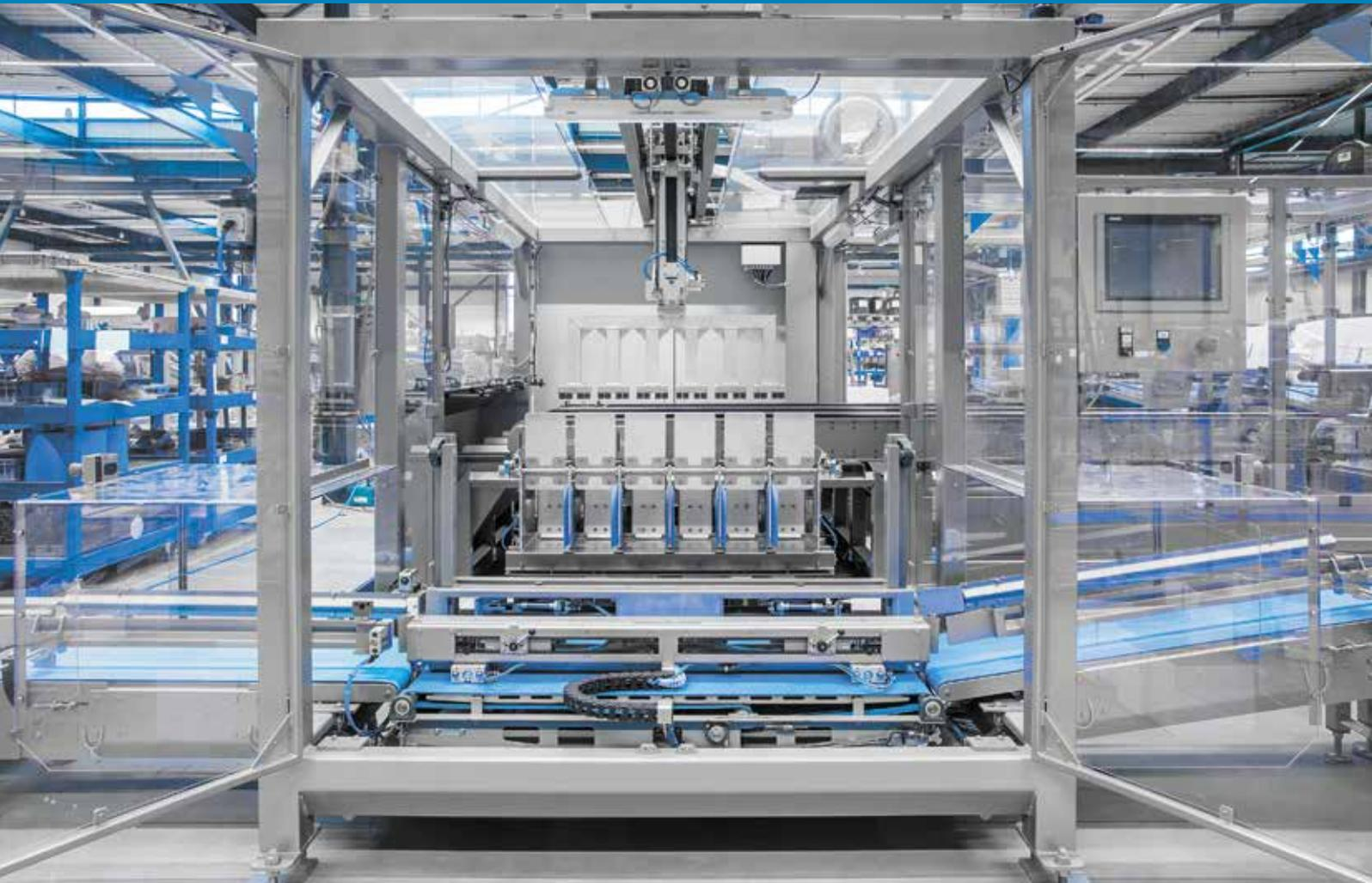
La serie Gantry ofrece una amplia gama de soluciones de encajado en horizontal y vertical para un sinnúmero de aplicaciones. Estas soluciones están diseñadas para encajar grandes volúmenes de bolsas procedentes de una o varias embolsadoras. Introducen envases primarios individuales en bandejas, cajas y otros tipos de embalajes secundarios. Los sistemas de BPA son altamente innovadores y superan en rendimiento a otras soluciones convencionales.
