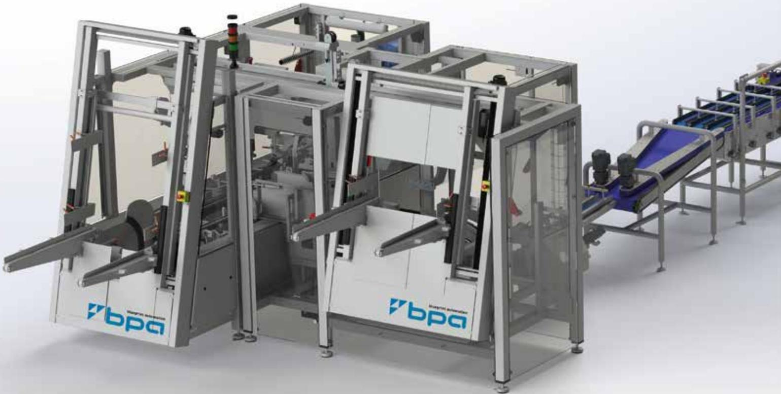
Используйте меньше материала для большей стабильности. Это основной принцип процедуры обертывания. Использование технологии обертывания позволяет значительно сократить расходы на упаковочный материал. Обертывание осуществляется с использованием высеченного материала коробки или лотка, который вплотную прилегает к продукту.
