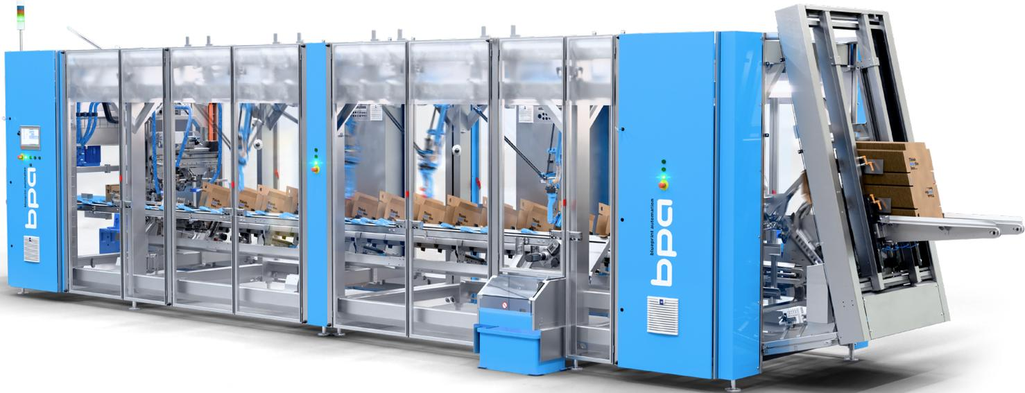
Weniger Material für mehr Stabilität. Auf dieser Formel basiert das Wrap-Around-Verfahren. Mithilfe der Wrap-Around-Technologie lassen sich die Kosten für Verpackungsmaterial deutlich senken. Wrap-Around-Kartons oder -Trays sind für das Verpacken von Produkten in gestanzten Verpackungen konzipiert, die direkt um das Produkt herum geformt werden.
