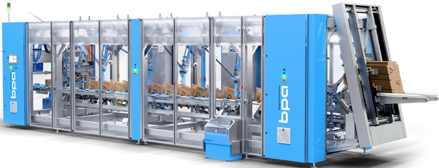
Menos cartón para una mayor estabilidad. Esta es la fórmula empleada en un procedimiento de *wrap around* (envoltura). La tecnología *wrap around* permite reducir notablemente los costes del consumible ligado al embalaje. Las cajas o bandejas tipo *wrap around* están diseñadas para embalar el productos partiendo de planchas de cartón troquelado, que se conforman alrededor del producto directamente.
